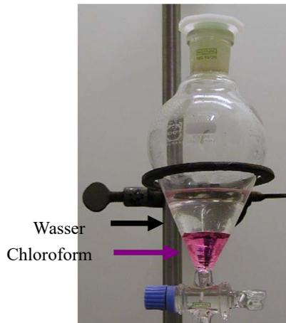
Extraktion von gelöstem Iod aus Wasser durch  $\text{CHCl}_3$
