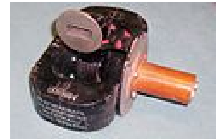
Impulsmagnetron MI-189W (ca. 9 GHz) Bordradar, Russia
