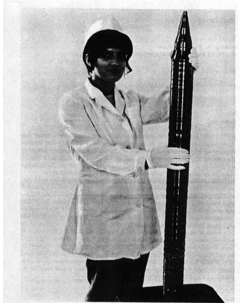
Abb. 1: Großer Silizium-Einkristall mit hoher Perfektion des Kristallbaus und extremer chemischer Reinheit. (Werkfoto der Wacker-Chemitronic, Burghausen; ich danke Dr. E. Lutz für dieses Bild.)
