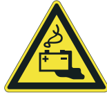
Gefahren durch Aufladen von Batterien
