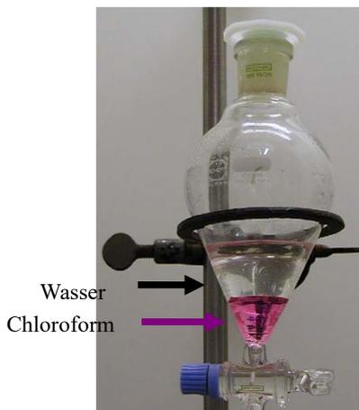
Extraktion von gelöstem Iod aus Wasser durch  $\text{CHCl}_3$
