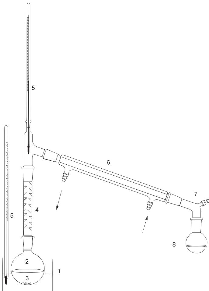
**Abb. 3.5:** Die aufzubauende Destillationsapparatur: 1: heating bath, 2: Distillation flask, 3: boiling chips, 4: Vigreux column, 5: Thermometer, 6: Liebig cooler, 7: Vakuumpfeife, 8: receiver
